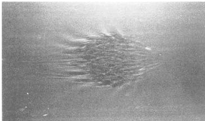
FIG. 3.11 – Spot observé dans un écoulement de Couette plan, autour du spot l'écoulement est parfaitement laminaire.
