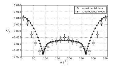
**FIGURE 11**. MEAN PRESSURE DISTRIBUTION AROUND THE CYLINDER AT AN INCLINATION  $\alpha = 5^{\circ}$
