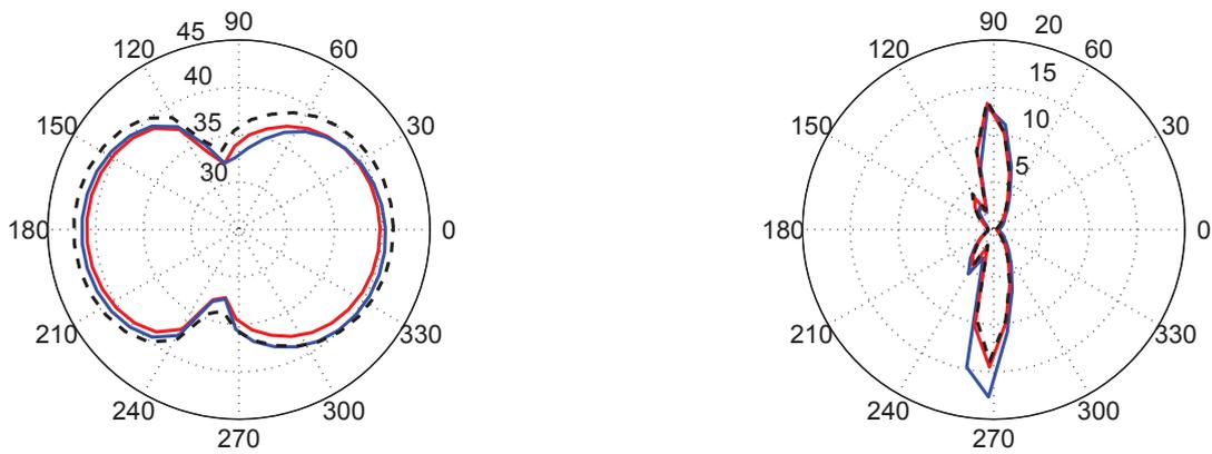
FIGURE 4 – Directivité horizontale à 100 m pour les atmosphères 1 (en rouge) et 4 (en bleu) du niveau de pression en dB(A) (gauche), et de l’amplitude de modulation en dB(A) (droite). Les courbes en tirets noirs correspondent aux résultats pour un vent constant de 7 m/s. Le vent souffle de la gauche vers la droite.
