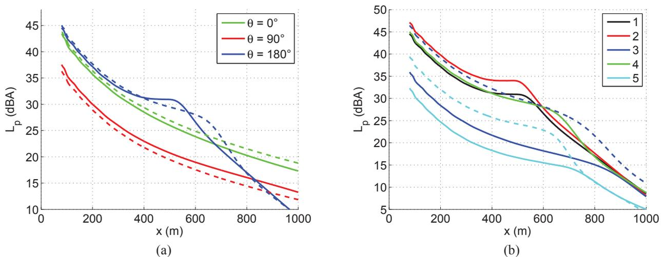
FIGURE 7 – Niveau de pression  $L_p$  en dB(A) en fonction de  $x$  pour  $z = 1, 5$  m (a) pour les atmosphères 1 (traits continus) et 6 (tirets) et pour différents angles de propagation  $\theta$ , et (b) pour  $\theta = 180^\circ$  pour toutes les atmosphères (traits continus pour les profils théoriques et tirets pour les profils mesurés).
