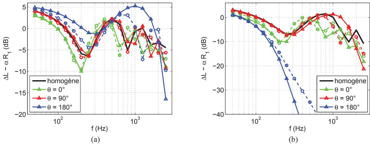
FIGURE 5 – Spectres en tiers d'octave de  $\Delta L - \alpha R_1$  pour les atmosphères 1 (triangles) et 4 (cercles) et pour différents angles de propagation  $\theta$  en  $z = 1, 5$  m et en (a)  $x = 500$  m et (b)  $x = 1000$  m.
