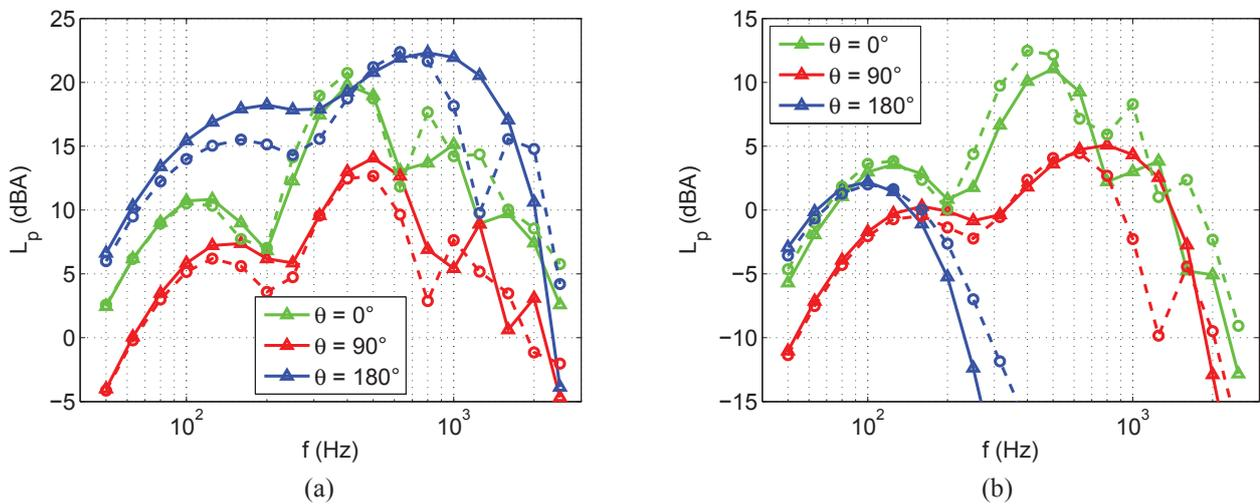
FIGURE 6 – Spectres en tiers d'octave du niveau de pression en dB(A) pour les atmosphères 1 (triangles) et 6 (cercles) et pour différents angles de propagation  $\theta$  en  $z = 1, 5$  m et en (a)  $x = 500$  m et (b)  $x = 1000$  m.
