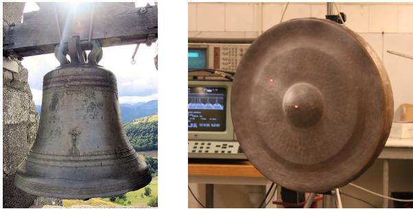
FIGURE 1: Photographies d'une cloche d'église et du gong viet-namien utilisé pour les mesures de cet article
