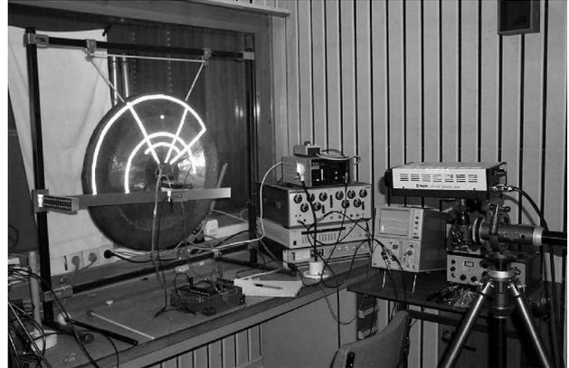
FIGURE 4 – Photographie du montage expérimental, ou comment les physiciens jouent du tam-tam ! Au centre du tam-tam, le dispositif d'excitation constitué d'une bobine et d'un aimant.
