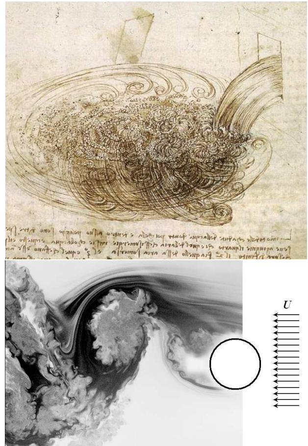
FIGURE 7 – Haut : dessin de Léonard de Vinci représentant les mouvements turbulents tridimensionnels d'une conduite d'eau débouchant dans un bassin. Bas : photographie d'un sillage turbulent derrière un obstacle cylindrique (cliché réalisé par Olivier Cadot à l'UME de l'ENSTA-ParisTech).
