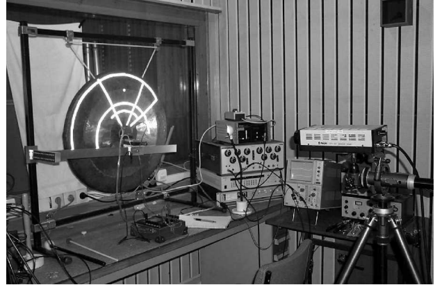
FIGURE 4 – Photographie du montage expérimental, ou comment les physiciens jouent du tam-tam ! Au centre du tam-tam, le dispositif d'excitation constitué d'une bobine et d'un aimant.
