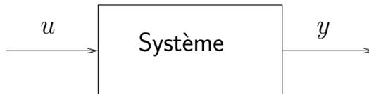
$u$  représente la commande, c’est-à-dire le moyen d’action sur le système, et la *sortie*  $y$  représente ce que l’on observe du système, généralement sous la forme de mesures.
