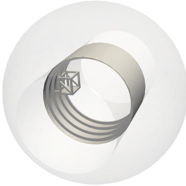
FIGURE 1 – Géométrie du cas d'étude, représentant un tronçon de coque cylindrique avec des raidisseurs en T et un carlingage générique. Le tronçon est en contact du fluide sur la face externe de la coque. Un effort ponctuel est appliqué verticalement au milieu de la plaque du carlingage. Une condition d'impédance est imposée sur la surface sphérique du domaine fluide, afin de mimer l'influence d'un domaine infini.
