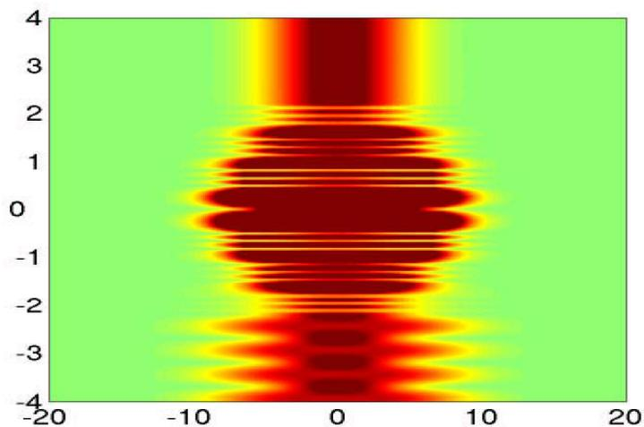
FIG. 1.28 – Solution pour un diamètre  $D=40.2\mu\text{m}$ , une fréquence relative  $F$  de 1.000732 (longueur d’onde de  $1.548866\mu\text{m}$ ), waist  $w = 9.92\mu\text{m}$ . La flèche est de  $20\text{nm}$  au centre de la cavité. Cas des bords courbes.
