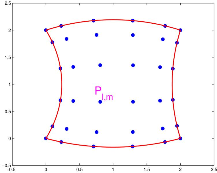
FIG. 1.6 – Projection des points de Gauss-Lobatto par la transformation de Gordon-Hall
