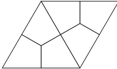
FIG. 3.2 – Motif élémentaire de maillage quadrilatéral déformé
