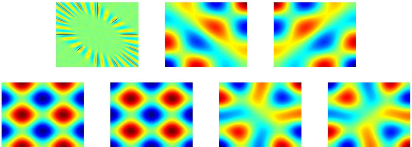
FIG. 6.16 – Quelques modes propres pour un maillage triangulaire découpé (approximation  $Q_5$ ).
