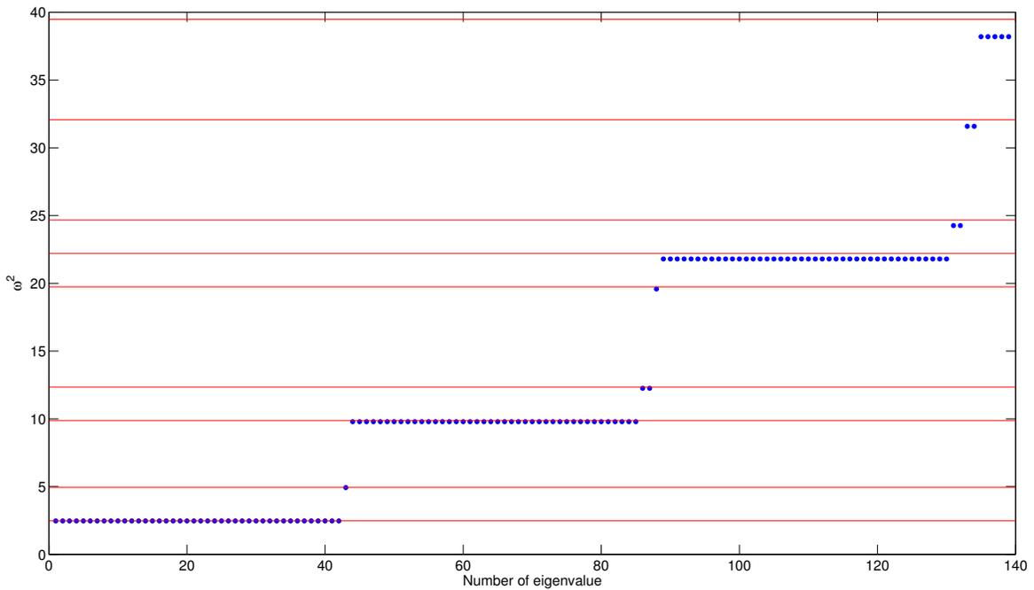
FIG. 4.10 – Distribution des valeurs propres sur un maillage 20x20 avec une approximation  $Q_1$ . Les traits rouges symbolisent les valeurs propres analytiques. Les points bleus représentent les valeurs propres numériques. Les décalages sont dûs à l'erreur de dispersion importante en  $Q_1$ .
