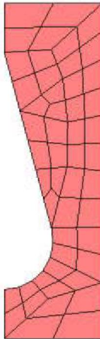
FIG. 8.8 – Maillage utilisé pour mesurer l'ordre de convergence
