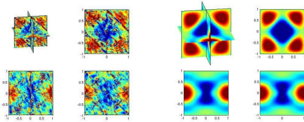
FIG. 6.11 – Champ  $E_x$  pour la formulation Galerkin discontinue (points de Gauss). À gauche sans pénalisation et à droite avec pénalisation  $\alpha = 0.5$ . On utilise le même maillage et une approximation  $Q_4$ .
