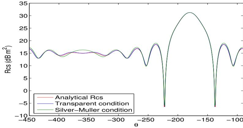
FIG. B.1 – SER d'une sphère parfaitement conductrice de rayon 1.  $k = 2\pi$ , la frontière extérieure du domaine de calcul est placée sur une sphère de rayon 2. En rouge, SER avec la condition transparente. En bleu, SER obtenue analytiquement. En vert, SER obtenue avec la condition de Silver-Müller. Le même maillage est utilisé, on compte 22 000 degrés de liberté.
