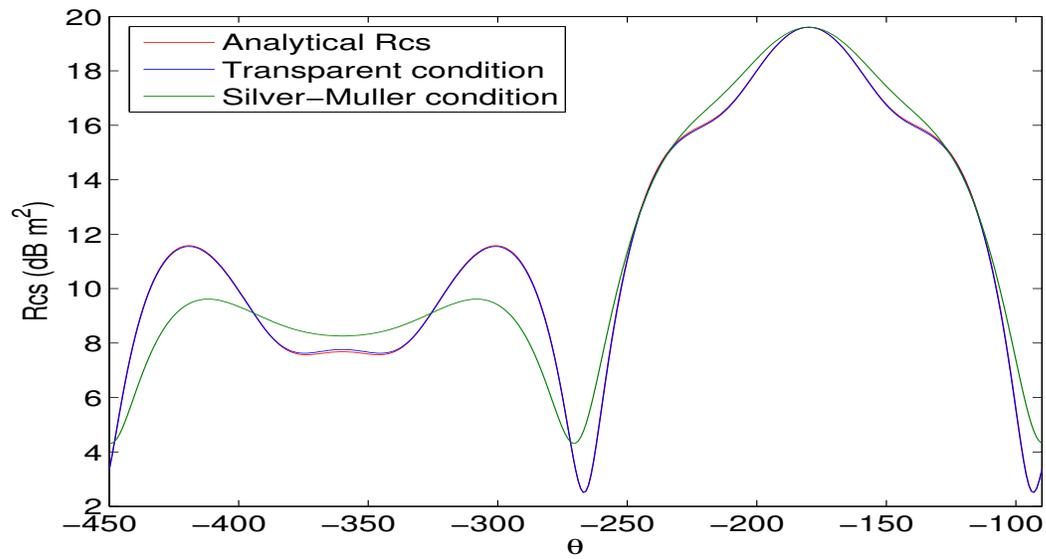
FIG. B.2 – SER d’une sphère parfaitement conductrice de rayon  $0.5$  .  $k = 2\pi$ , la frontière extérieure du domaine de calcul est placée sur une sphère de rayon  $0.6$  . En rouge, SER avec la condition transparente. En bleu, SER obtenue analytiquement. En vert, SER obtenue avec la condition de Silver-Müller. Le même maillage est utilisé, on compte  $5\,200$  degrés de liberté.
