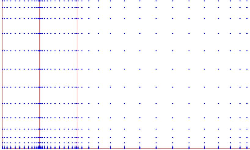
FIG. 9.7 – Distribution des points d'intégration pour la technique "Gauss-squared".
