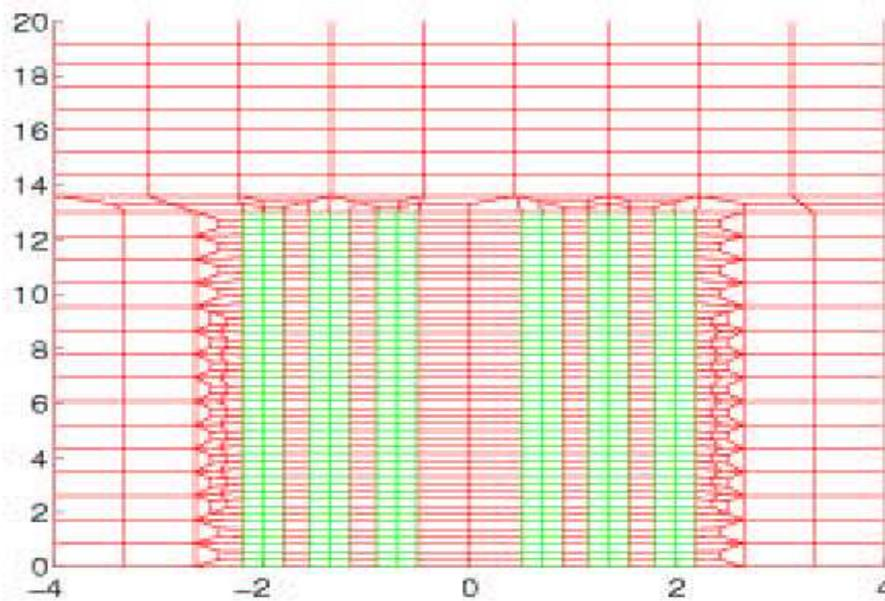
FIG. 1.23 – Maillage du domaine  $x \geq 0$  utilisé avec les éléments  $Q_5$ . Les diélectriques sont en vert. Les unités sont comptées en  $\lambda_0 = 1.55\mu m$  : les longueurs physiques sont obtenues en multipliant par  $1.55\mu m$ .
