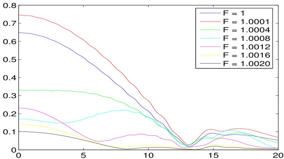
FIG. 1.26 – Module du champ transmis  $|u(x, z = Z)|$ ,  $x > 0$  pour un dispositif de diamètre  $D=40.2\mu\text{m}$ , et un waist  $w = 9.92\mu\text{m}$ . Le  $Z$  correspond à 4 longueurs d'onde en aval du filtre. Axe horizontal : axe parallèle au barreau  $x > 0$ . Les différentes courbes correspondent à un balayage en fréquence ou encore un décalage en longueur d'onde variant de  $-3.094\text{nm}$  à 0.
