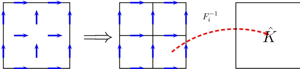
FIG. 5.15 – Sous-maillage  $Q_1$  d’une cellule élémentaire  $Q_2$ . transformation  $F_i$  pour passer du carré de référence vers un petit carré du sous-maillage.
