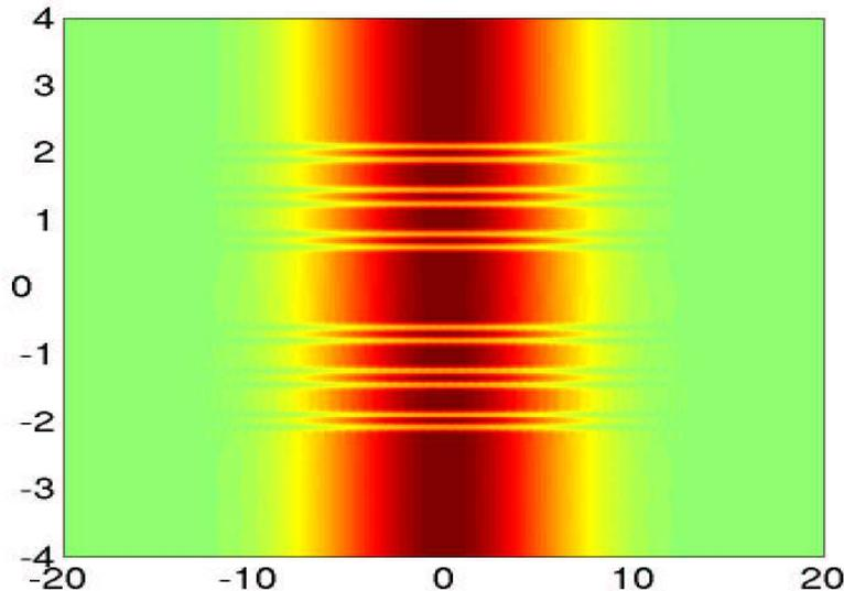
FIG. 1.24 – Module du champ total pour une fréquence relative de 0.8 (ce qui correspond à augmenter la longueur d'onde de  $\frac{1}{0.8}$  par rapport à  $\lambda_0$ ) et un waist de  $w = 4.96\mu\text{m}$
