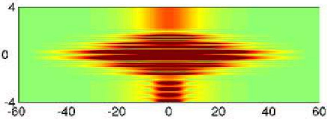
FIG. 1.25 – Diamètre de  $173.6\mu\text{m}$ , fréquence relative de 1 (la longueur d'onde est  $1.55\mu\text{m}$ ), waist  $w=9.92\mu\text{m}$ . Les unités sont comptées en  $\lambda_0 = 1.55\mu\text{m}$  : les longueurs physiques sont obtenues en multipliant par  $1.55\mu\text{m}$ .
