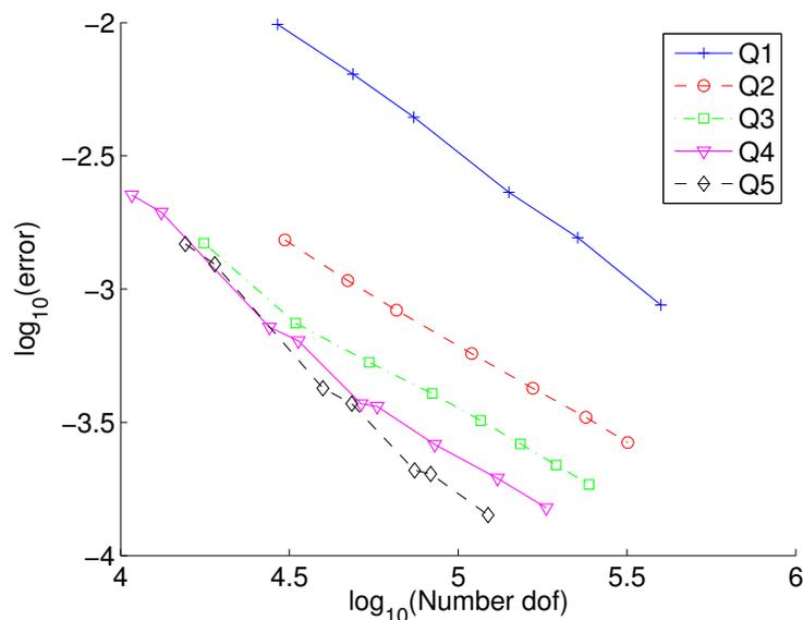
FIG. 6.7 – Evolution de l'erreur sur  $H$  entre la solution numérique et la solution de référence en fonction de  $h/(r+1)$ , où  $h$  est le pas de maillage,  $r$  l'ordre d'approximation. Echelle log-log. Cas du carré sur des maillages triangulaires découpés.
